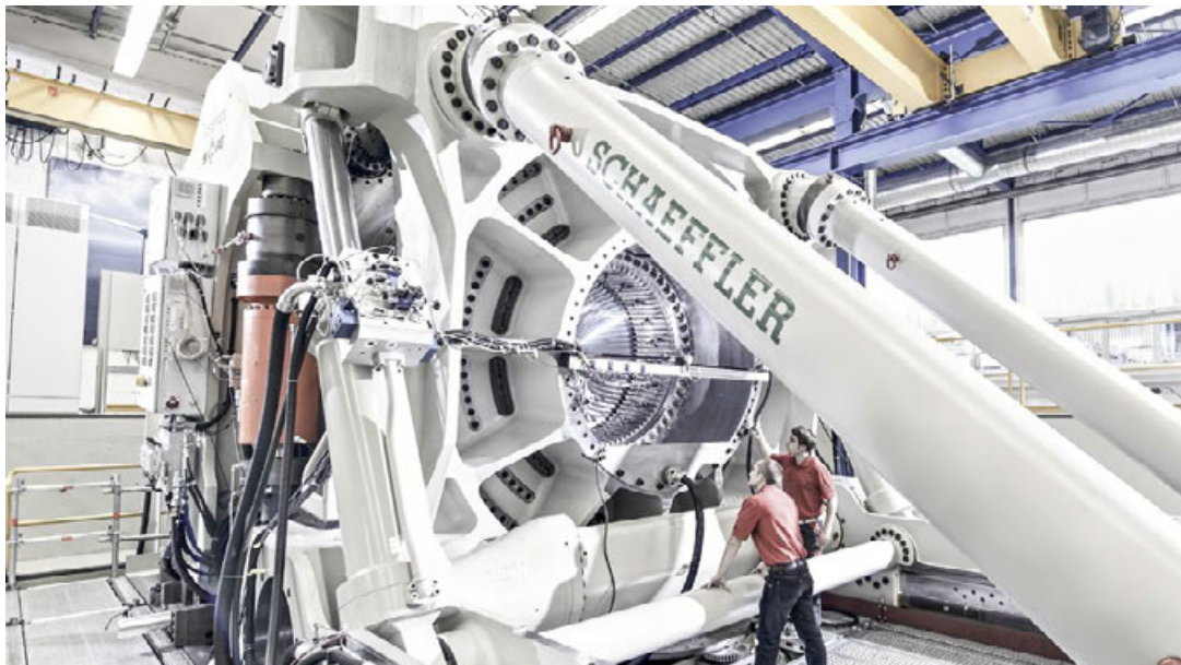
Meterware: Großlager- prüfstand Astraios in Schweinfurt
